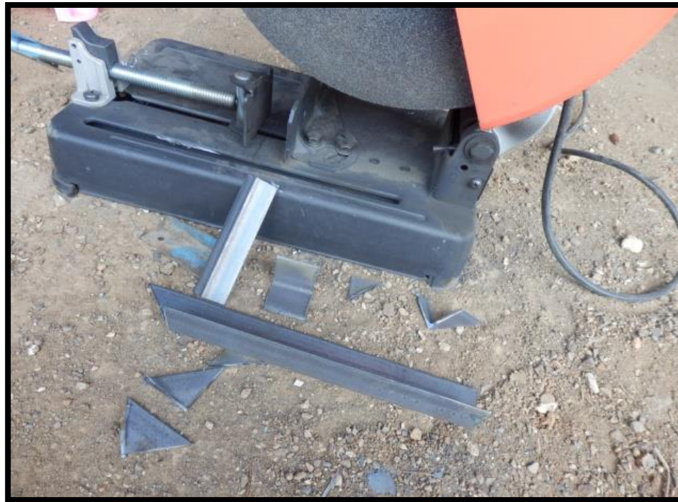
ภาพที่4-1 ตัดเหล็กฉาก
