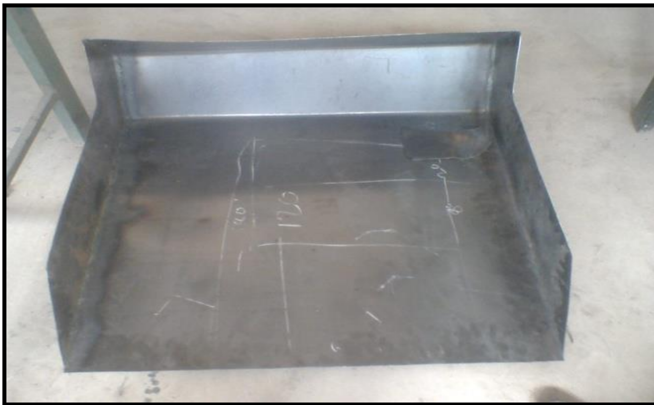
ภาพที่ 4-11 ถังรองรับน้ำมัน
